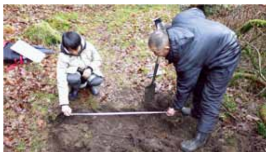
写真-41 園路幅1m 埋没厚15cm
