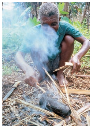
写真12 バナナの軸を心材に、陶土で羽口を形成する
