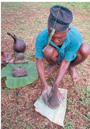
写真12 バナナの軸を心材に、陶土で羽口を形成する
