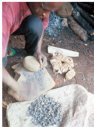
写真10 火から取り出した鉄鉱石を細かく砕く
