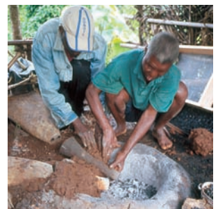
写真14 作業場の地面に穴を掘り、その周囲に石を並べていく
