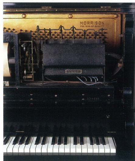
フィゴから送られてきた空気をロール紙に伝達する装置
